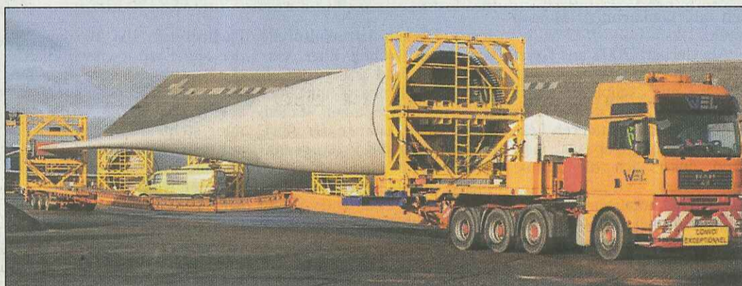
Mit diesem Schwerlastkraftwagen werden die 62 Meter langen und 22 Tonnen schweren Flügel aus Dänemark, wo sie hergestellt wurden, zum Elbehafen transportiert.
