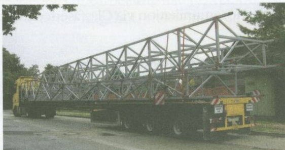
Formunterbau für Rotorblatfertigung//Mould frame for rotor blade manufacturing
